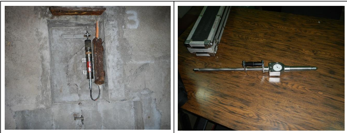
Fotografía 6.7 Izq. Calibradores extensométrico eléctrico – Der Medidor extensométrico mecánico
